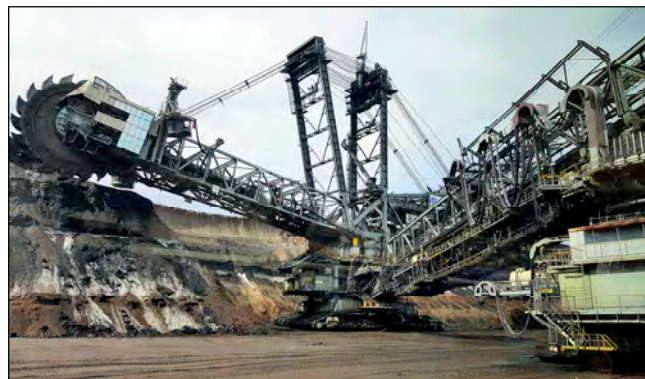
Der Schaufelradbagger kann täglich bis zu 240.000 Tonnen Kohle oder Abraum bewegen
