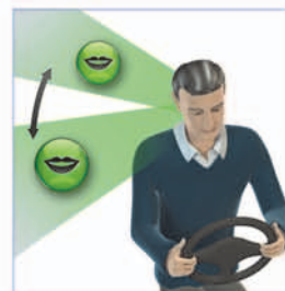
auto ZoomControl - automatische Fokussierung auf die Richtung, aus der die Stimme kommt
